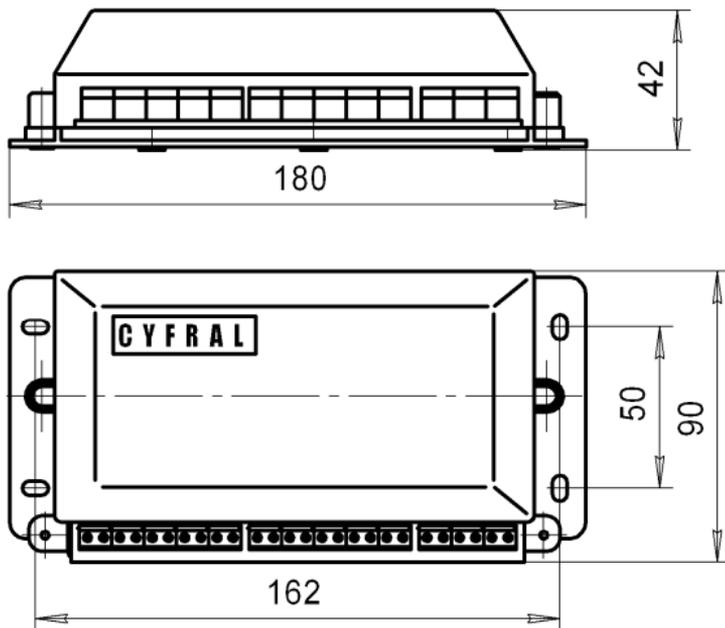
Рисунок Г.1 Габаритные и установочные размеры коммутаторов
