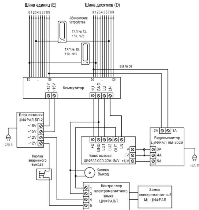
(для варианта исполнения «VC» использовать видеомонитор ЦИФРАЛ ВМ-3020)
