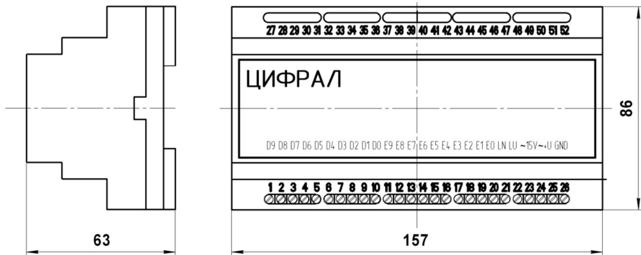
Рисунок Г.2 Габаритные и установочные размеры коммутатора
