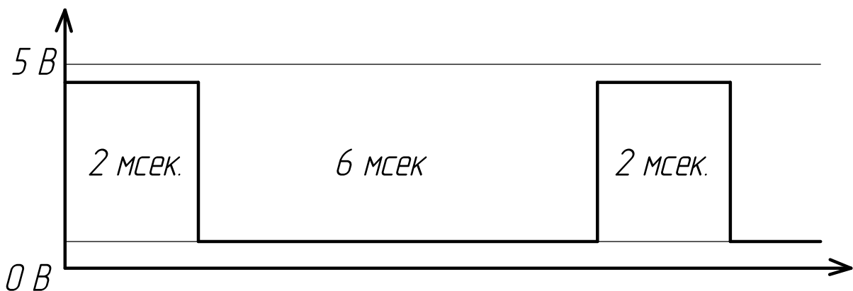
Рисунок 1. Форма и длительность импульсов на выводах микросхемы DD1
